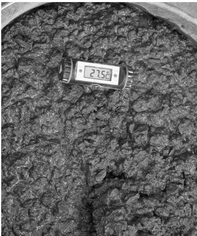
Bild 7: Vermehrte Kontrolle der Frischbetontemperatur auch nach Probekörperherstellung
